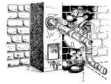
Zum Verschließen der Öffnung im Bereich des Anschlussstückes ist das Wandfutter hilfreich. Es erleichtert das Einsetzen und wandbündige Vermörteln der Mauersteine.
